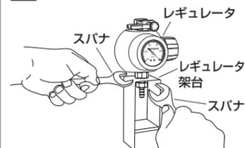
レギュレータ架台にレギュレータを取り付ける際は、図のようにスパナを2本使用して固定してください。
