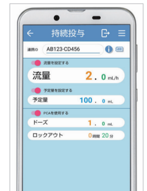
6 流量、予定量、PCAドーズ及び ロックアウトタイムを設定します。
