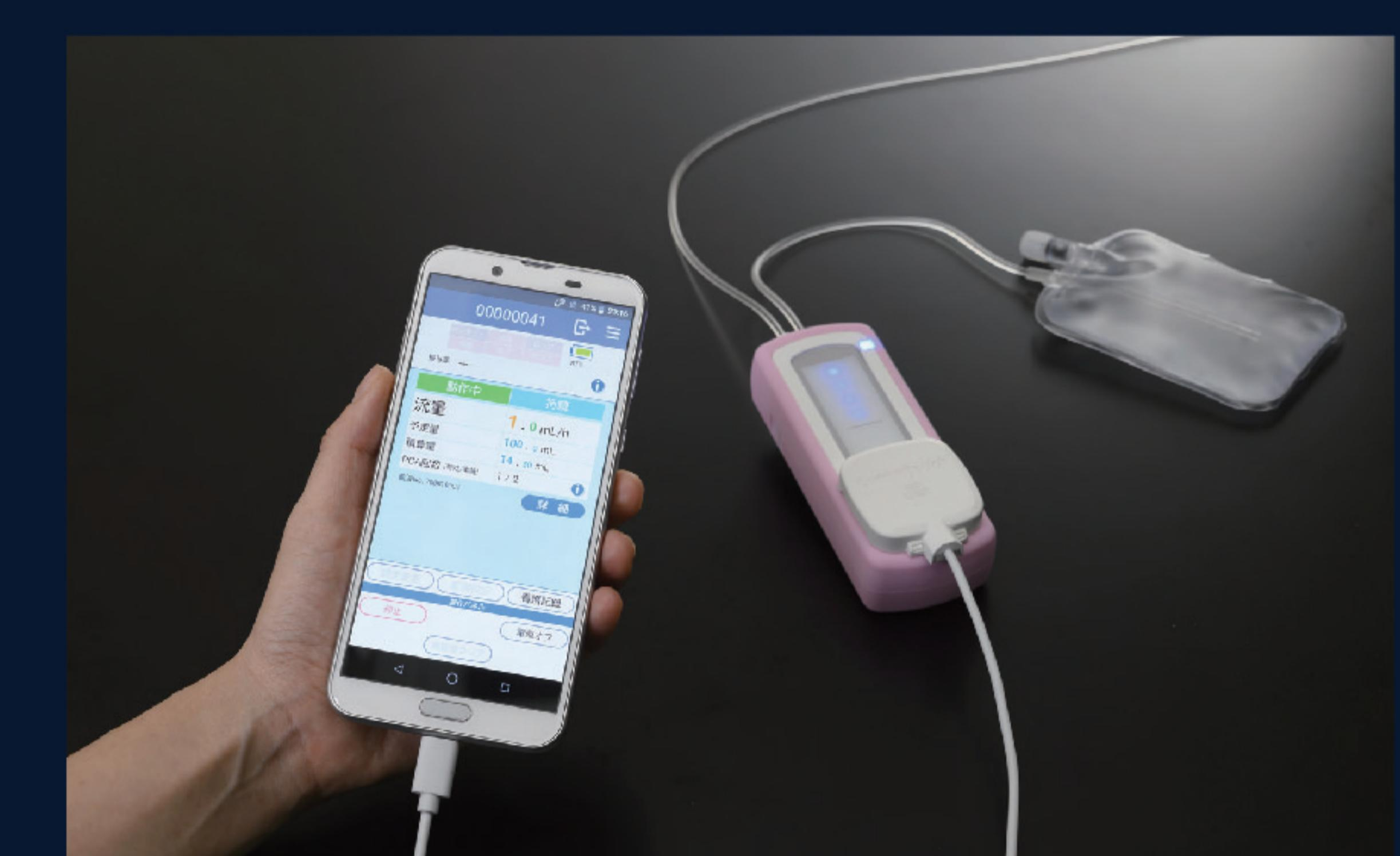
輸液状況の確認は、すべてスマートフォンアプリにより専用の通信モジュールを介して行います。
