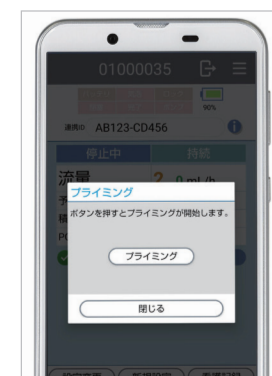
8 プライミングを行い 積算量をクリアします。
