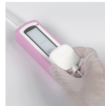
5 コントローラに接続した コムタッチを、ドライブユニットに 接続します。
