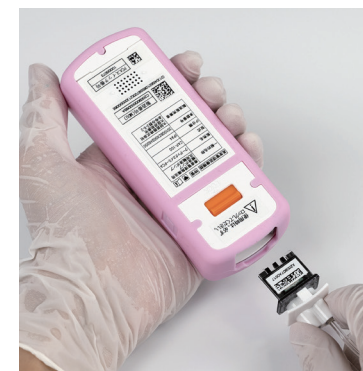
3 ポンプユニットを ドライブユニットに装着します。
