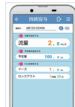
6 流量、予定量、PCAドーズ及び ロックアウトタイムを設定します。
