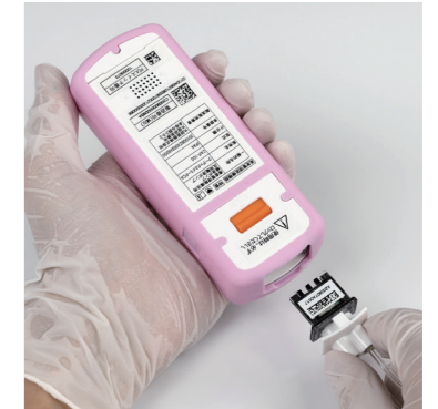
3 ポンプユニットを ドライブユニットに装着します。
